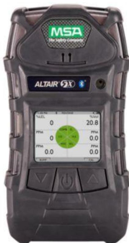
Das Gasmessgerät ALTAIR 5X kann gleichzeitig bis zu sechs Gase messen und ist jetzt auch mit integriertem PID-Sensor zur Erkennung flüchtiger organischer Verbindungen erhältlich. Gestützt auf die fortschrittliche MSA XCell® Sensor Technology bietet das Gasmessgerät ALTAIR 5X schnellere Ansprechzeit, höhere Stabilität und Genauigkeit, längere Nutzungsdauer und Kosteneinsparungen während der gesamten Gerätelebensdauer.
